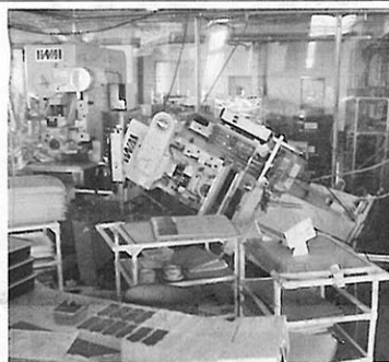
東日本大震災で機械が転倒した工場内部 (NPO法人東海リスクマネジメント研究会提供)
